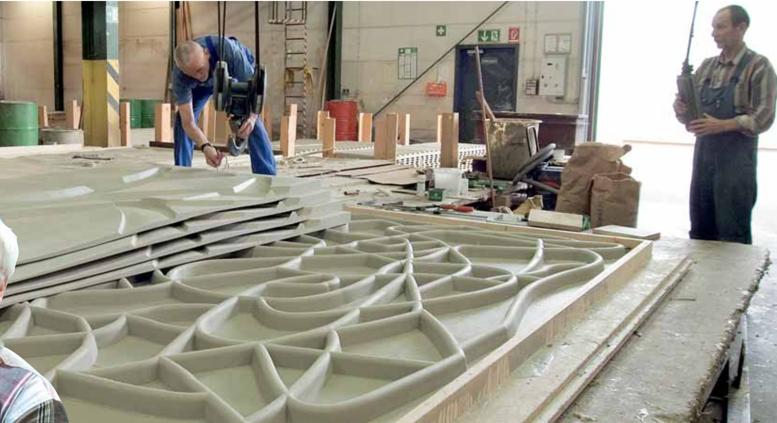
Die Reckli-Mannschaft kann nahezu jedes beliebige Muster nachahmen. Der Schlüssel zur Schönheit in Beton sind elastische Matrizen. Weil die Nachfrage groß ist, erweitert das Unternehmen gerade wieder (Bild unten).
