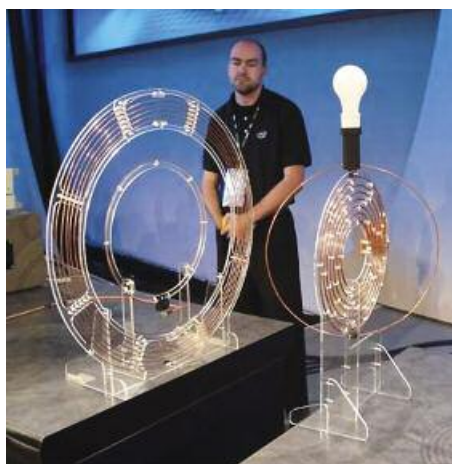
Es werde Licht: Intel hat bereits öffentlich demonstriert, wie man eine Glühbirne mithilfe des Prinzips der Induktion ganz ohne Kabel zum Leuchten bringt.
